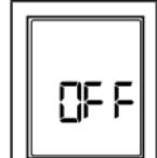
8. En la pantalla aparece la indicación "OFF". El termómetro se apaga automáticamente pasados 2 segundos.
