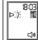
4. Insérez délicatement la pointe du capteur et appuyez sur la touche SCAN pendant une seconde. Pendant le processus de mesure, le symbole « °C » clignote sur l'écran.
